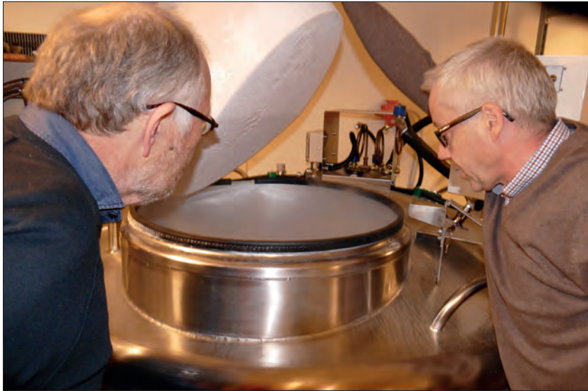
Figur 3: Biobanken ved HUNT er høyteknologisk. Her oppbevares prøver ved minus 80 grader Celcius. Et datastyrt gjenfinningsystem kan plukke fram prøver til fornyet analyse på kort tid. På bildet sees en av ståltankene med flytende nitrogen til innfrysing. Professorene Nylenna og Krokstad kikker ned i – men ikke for lenge. (Foto: Øivind Larsen)
