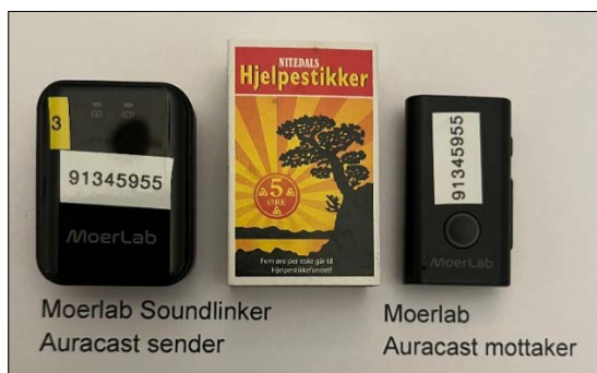
Figur 3. En mikrofon med sender (til venstre) og mottaker (til høyre) basert på auracast-teknologi. Mikrofonen festes på brystet til den som snakker og mottakeren kobles til hodetelefoner. Foto: Lars Erik Eriksen
