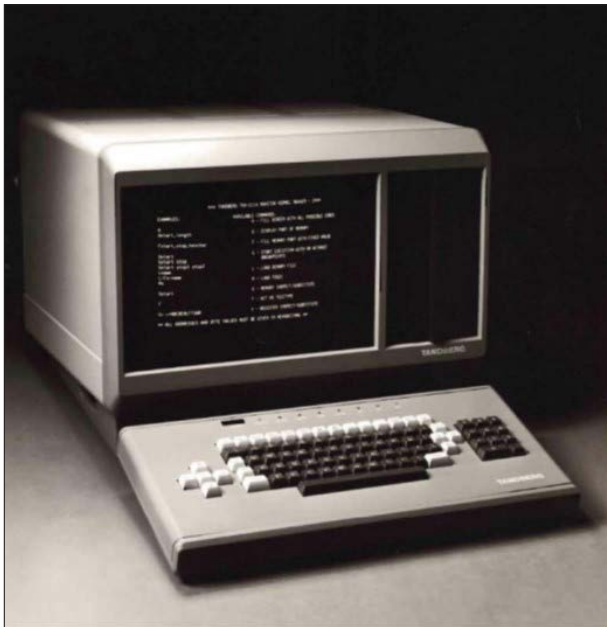
Figur 1: Den norskproduserte intelligente terminalen TDV 2124 fra Tandberg Data var kanskje verdens første PC. Den hadde eget diskettbasert operativsystem, og innebygget 8-tommers diskettstasjon på størrelse med en stor skoeste. Foto/Kilde: Øiesvold Reklamestudio AS, Oslo.
