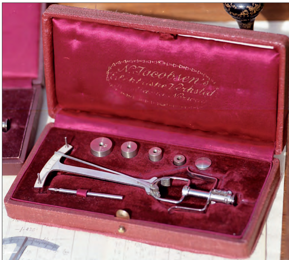
Figur 49: Professor Hjalmar Schiøtz' (1850–1927) tonometer til måling av trykket i øyet ved mistanke om grønn stær er genialt i sin enkle konstruksjon. Det ble lansert i 1905, vakte internasjonal oppsikt og dominerte i mer enn 50 år. Selv om det senere er kommet mer nøyaktige måleinstrumenter, anvendes det fortsatt enkelte steder. (Se Ytteborg J. Hjalmar Schiøtz og hans tonometer. Tidsskr Nor Lægeforen 2001; 121: 464-5, og Johansen O. Øyelegekunstens historie i Norge. Oslo: Norsk oftalmologisk forening, 1978.) (Foto: Øivind Larsen 1989)
