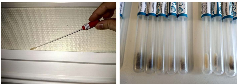
Figur 4. Prøvetaking av støvprøver til massesekvensering.
